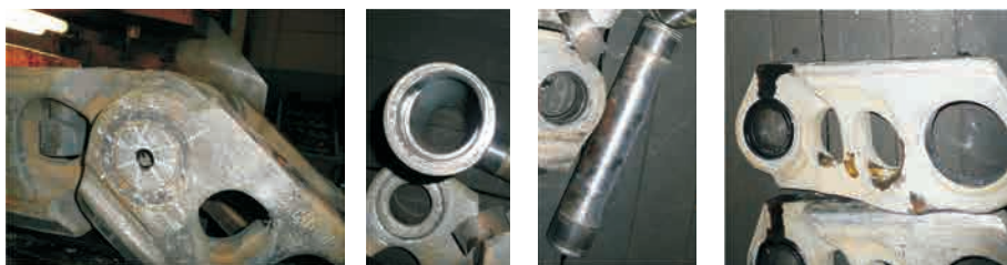
Замена изношенного пальца, втулки и уплотнения траковой цепи
