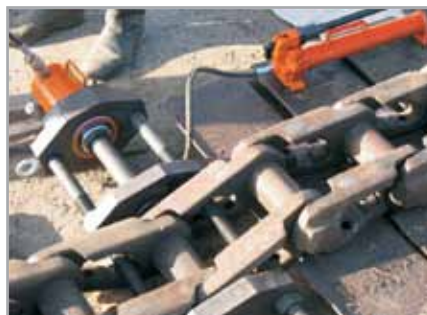
ВПТЦ50. Выпрессовка и запрессовка пальца Т170
