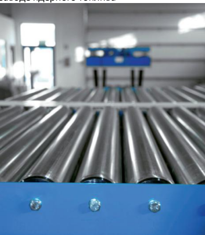
Гидравлический стол-конвейер, судостроительный цех
