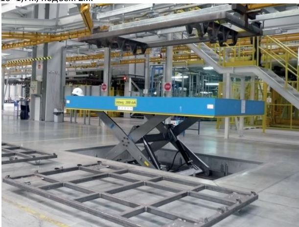
Промышленный подъёмный стол для специального применения на автомобильном заводе
