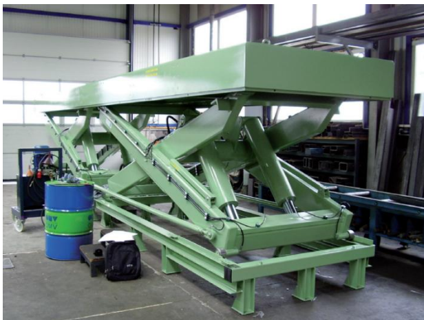
Подъёмный стол с грузоподъёмностью 20 тонн, платформа 10x1,7м, подъём 2м.
