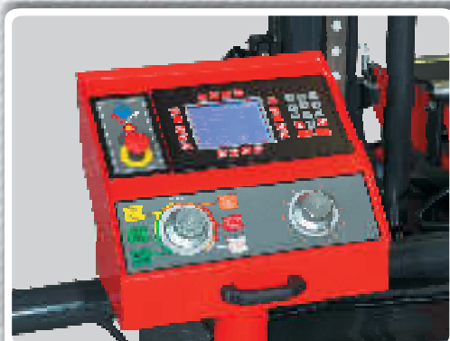
Инвертор PLC контроллер Регулировка подачи Гидравлический тормоз
